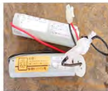
二次電池(非常灯電池)
