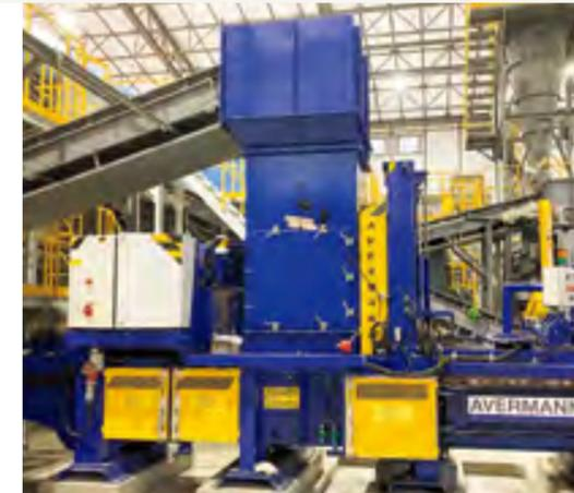
光学選別機により、RPFに適さないと判断された軽量物は圧縮結束され、輸送効率を向上させたのち当社秋古工場で焼却処理を行います。将来的にはこれら原料もBグレードRPF向けとして活用する計画です。
