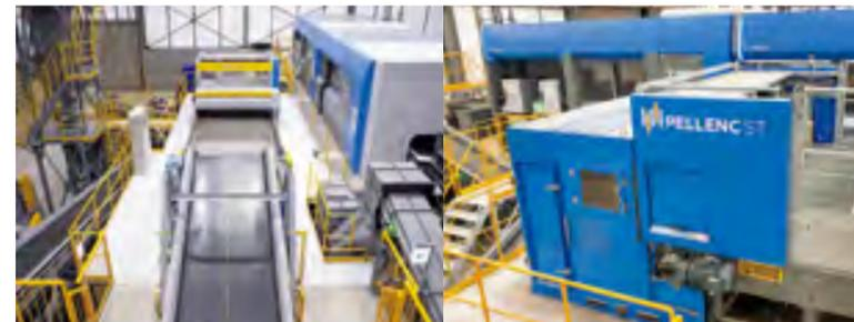
機械選別機により分離された重量物は自動選別ラインに送られ、金属類を除去した後、AI搭載廃棄物選別ロボットによる自動選別を行います。このロボットは人工知能を活用し、指定した対象物をピックアップする最新技術です。選別精度を高めると同時に人為的なミスを防ぎ、安全を確保しながら工場作業の省人化・効率化を実現しました。
