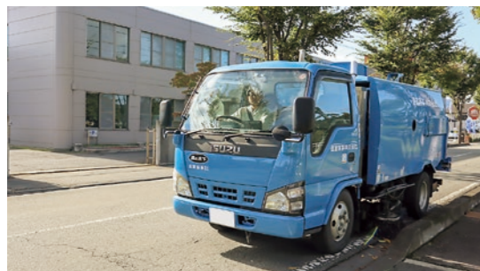
路面清掃車で工業団地内の道路を清掃しています。
